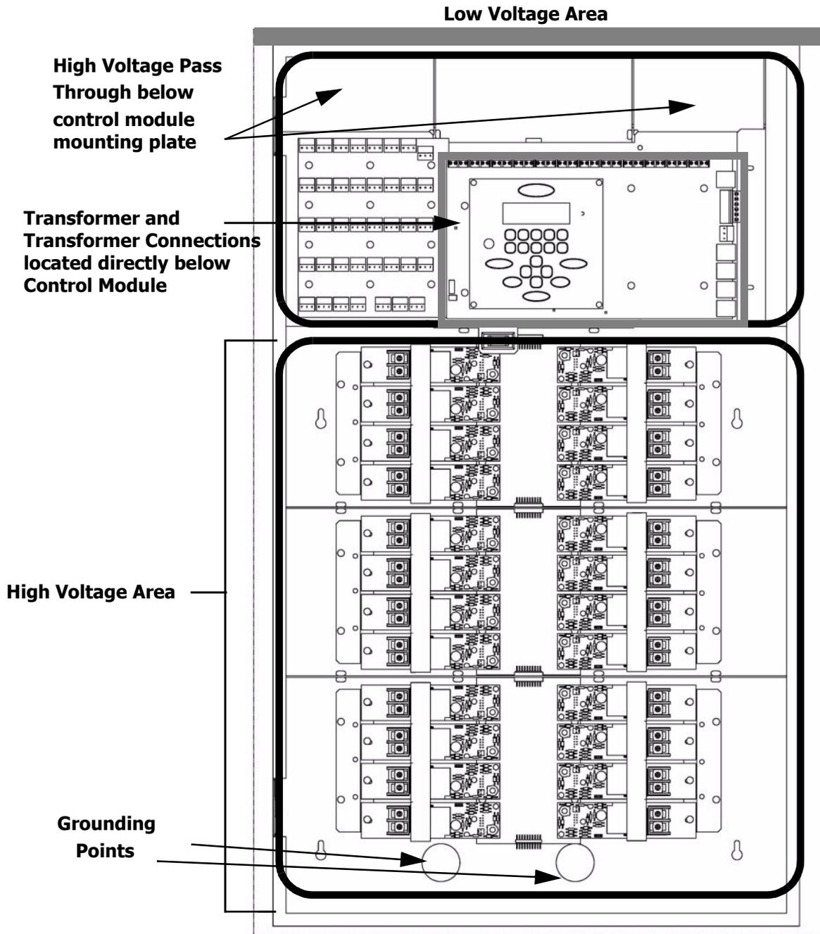
Figure 2: 24-Relay Cabinet Conduit Entry
