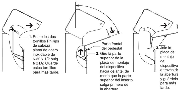
8. Conecte los cables al receptáculo e instale la placa de montaje del dispositivo con los tornillos suministrados. (La imagen que se muestra a continuación es un receptáculo ICFT y una placa de montaje de dispositivo de un solo gancho).
