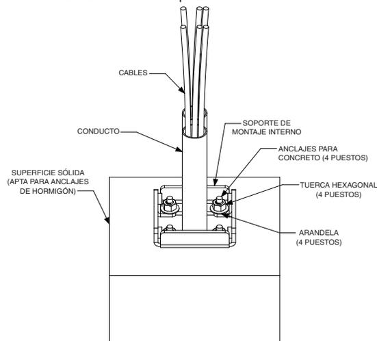
6. Instale el pedestal sobre el soporte de montaje interno utilizando cuatro (4) tornillos hexagonales de cabeza plana de 1/4 pulg.-20 x 7/16 pulg.
