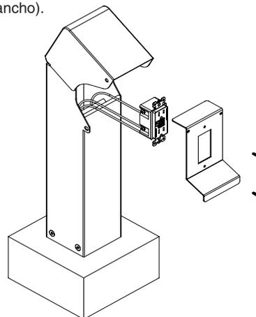
9. Coloque la placa de montaje del dispositivo cableado en el pedestal siguiendo los pasos 1-3, como se muestra en las imágenes a continuación. **NOTA:** Las imágenes se muestran sin cables sólo como referencia.
