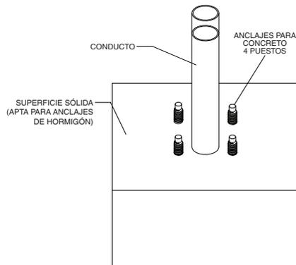
4. Instale el soporte de montaje interno en los cuatro anclajes con cuatro arandelas y cuatro tuercas hexagonales.
